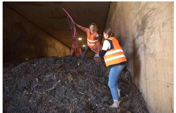
Abbildung 2: Entfernen der Rottenetze und der eingelegten Proben nach der 21-tägigen Kompostierung.
