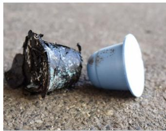
Abbildung 4: Kaffeekapsel nach der Kompostierung (links) und Ausgangsprodukt vor der Kompostierung (rechts).
