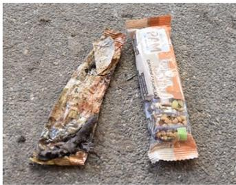
Abbildung 3: Riegelolie nach der Kompostierung (links) und Ausgangsprodukt vor der Kompostierung (rechts).
