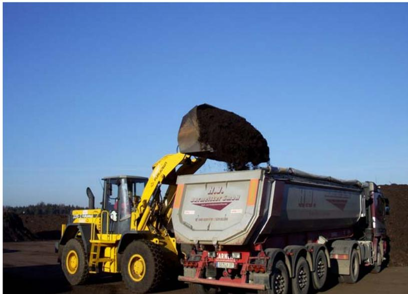
Verladen von Oberbodenmaterial (aus aufbereitetem Erdaushub und Kompost) für eine Baustelle
