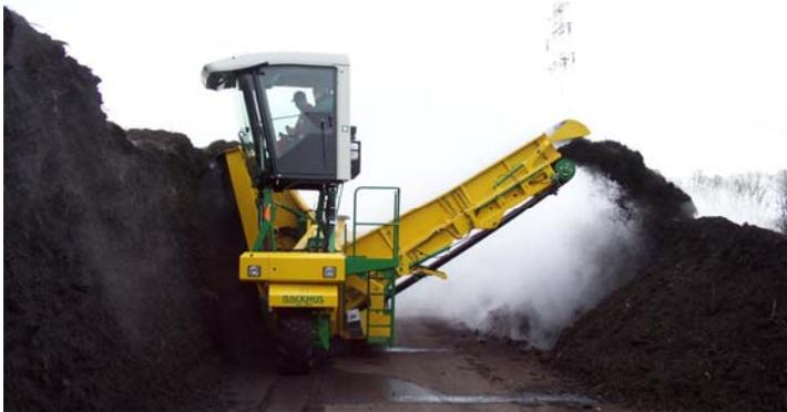
Mietenumsetzgerät. Linker Teil der Tafelmiete wird abgefräst und rechts neu aufgesetzt.
