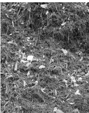
Siebreste > 24 mm werden in die thermische Verwertung entsorgt
