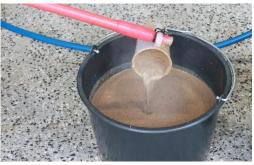
Probenahme mittels Probenschöpfer an Teleskopstange (z.B. bei Entnahme aus offenen Behälter) und Zusammenführung zur Sammelprobe
